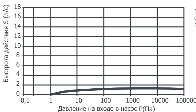
График зависимости быстроты действия от давления на входе с открытым газобалластом
