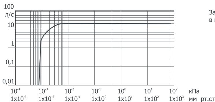
Зависимость быстроты действия на входе
